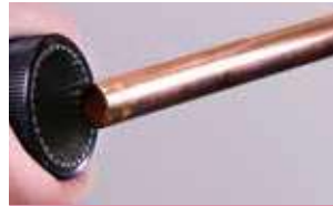
2. Entgraten und entfernen Sie alle äußeren scharfen Kanten
